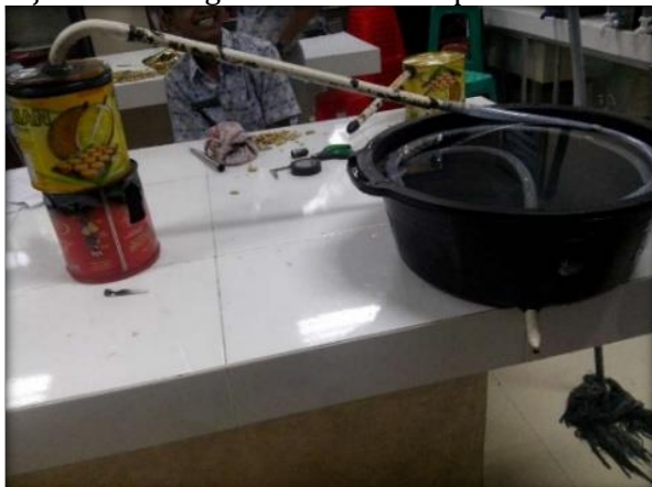
Gambar 3. Alat pengolah sampah plastik menjadi bahan bakar
